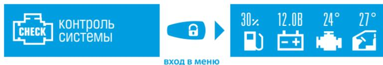
! Индикация температуры двигателя возможна только при подключенном датчике температуры. Наличие датчика зависит от комплектации системы. Индикация уровня топлива только при дополнительном подключении или наличии информации в CAN-шине.
