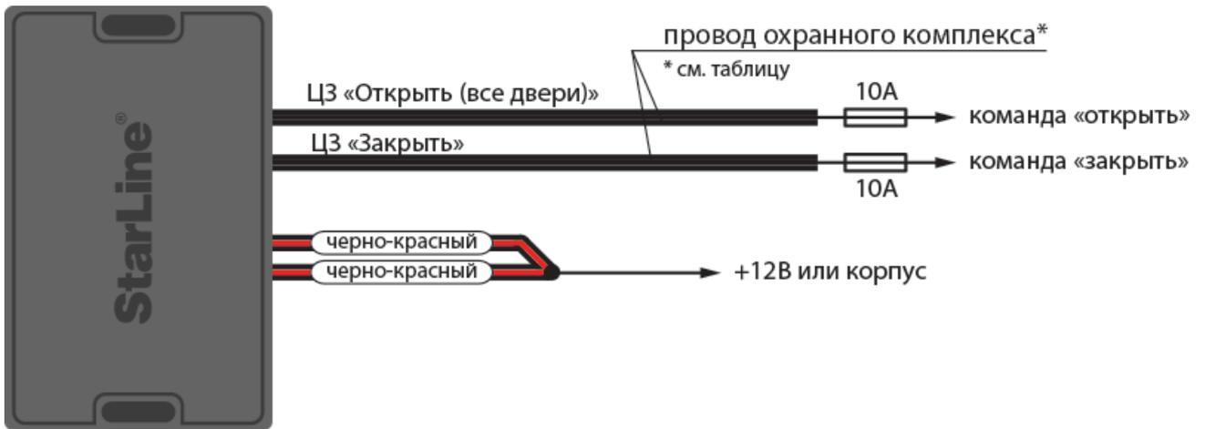
Схема аналогового подключения центрального замка с положительным или отрицательным силовым управлением для охранных комплексов StarLine A96/A66, B96/B66, D96/D66, AS96 (v2)
