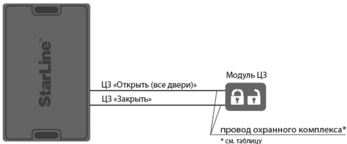
Схема аналогового подключения центрального замка для охранных комплексов StarLine E96/E66, S96/S66, M96, X96 (v2)
