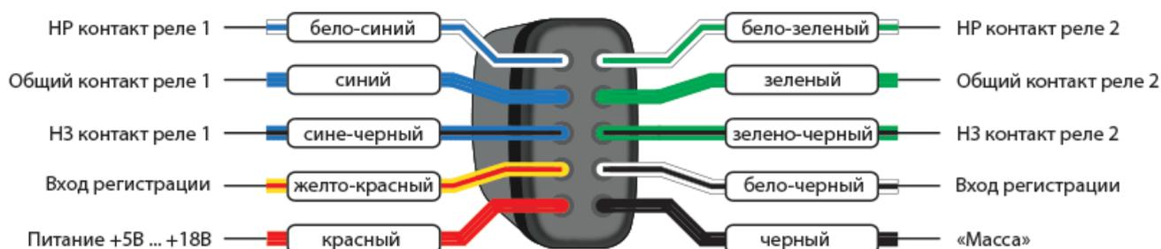
При параллельном соединении двух контактных групп обоих реле максимально допустимый ток будет не более 1А.
